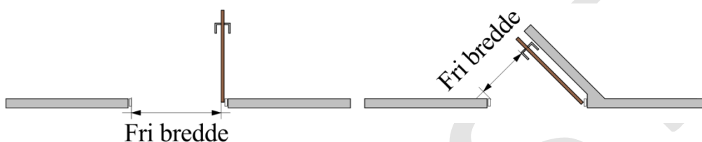
Figur 2.20. Måling af en dørs frie bredde ved henholdsvis en åbning på 90° og ved åbning på mindre end 90°.
