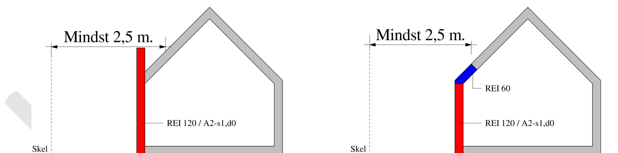
Figur 4.19. Brandvæg ved skel. Venstre side viser brandkam og højre side viser brandkamserstatning. Alle klassifikationer er minimumskrav.
